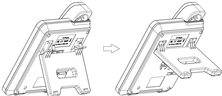
安装支架: 将支架的卡扣对准支架板下面两个卡口后, 手托住支架向上轻轻推一下即可. (如上图)
